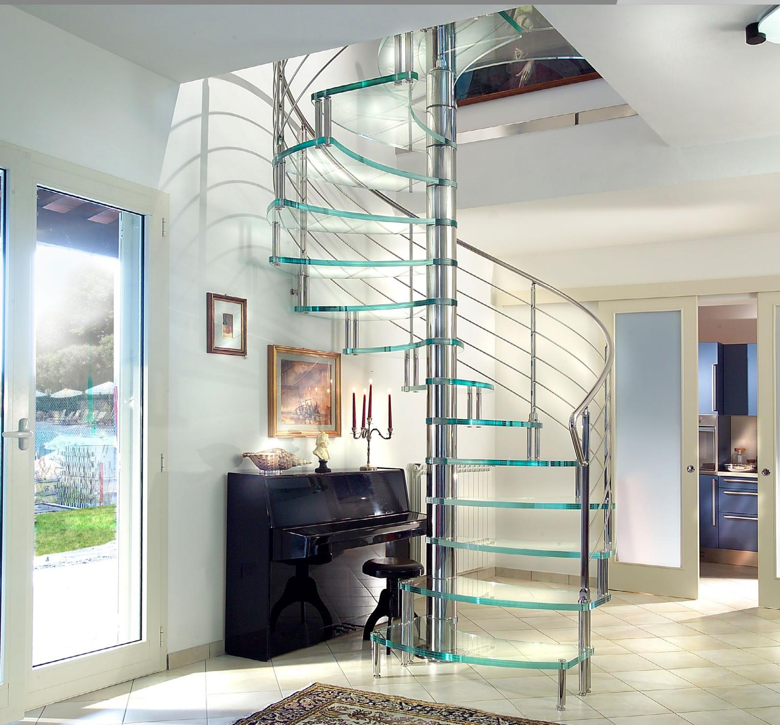
**STRUCTURE** : composée d'un axe central en acier inoxydable avec bagues intercalaires en inox
